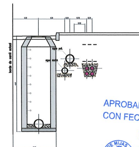
Detalle Arqueta Saneamiento 4 m profundidad
